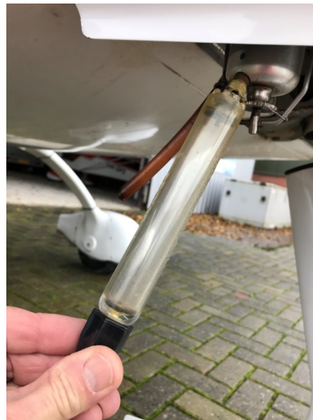
Afbeelding 35: Aftappen vuil en water.
