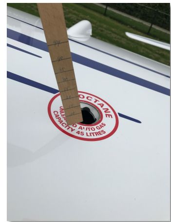
Afbeelding 52: Peilen van de brandstof.
