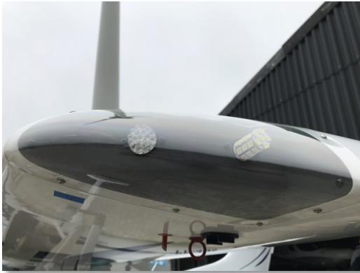
Afbeelding 26: Vleugeltip met strobe en nav verlichting.
