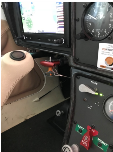
Afbeelding 14: rode handel en oranje veiligheidspen.
